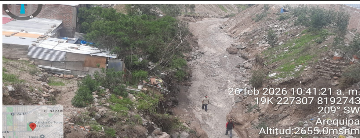
IMAGEN 01: SE MUESTRA LA COLMATACION D ELA QUEBRADA GAMARRA DONDE SE PROPONE CONSTRUIR 01 DIQUE TRANSVERSAL PARA MITIGAR LA EROSION Y HUAYCOS AGUAS ABAJO
